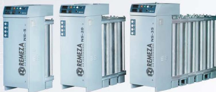
Молекулярное сито задерживает молекулы газа, которые нужно отделить, и пропускает молекулы газа, которые нужно получить. Простое, быстрое и безопасное расширение модульной системы позволяет добавлять модули без полной разборки устройства, чтобы избежать риска контаминации (загрязнения) молекулярного сита внутри цилиндра. Если вы хотите удвоить или даже утроить производительность вашего генератора азота, то выберите опцию DUAL BANK, одна система управления способна содержать до двух DUAL BANK'ов.
